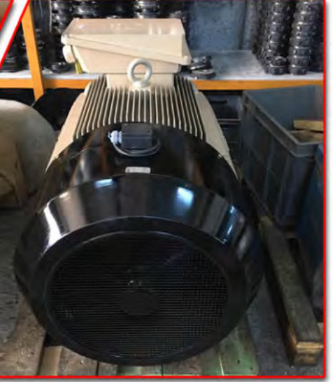
315 Tip Aksiyel Cebri Fan Uygulaması (Type 315 Axial Force Fan Application)
